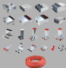
Das ValloFlex Rohrsystem ist ein spezielles, für die Lüftungstechnik entwickeltes, flexibles Lüftungsrohr aus PE, zur Verteilung der Zu- und Abluft innerhalb des Gebäudes. Es verfügt über einen zweischichtigen Aufbau, außen gewellt, innen mit glatter, antistatischer und mikrobenfester Innenhaut. Einfache Verlegung im Estrich, der Beton- und Holzdecke, in der abgehängten Decke sowie Wand.
