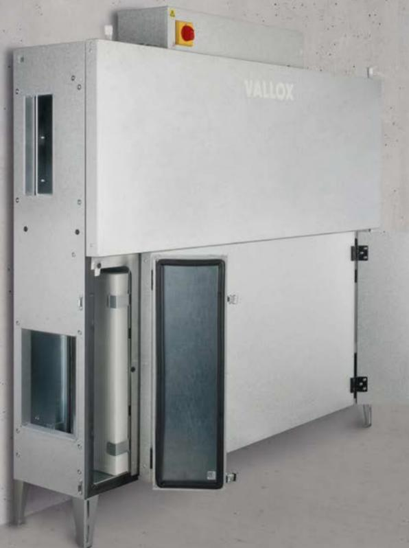
Die VARIO-Serie sind hocheffiziente Zu- und Abluftgeräte mit Wärmerückgewinnung. Die platzsparenden Kompaktgeräte werden bei Innenaufstellung sowohl als Stand-, als auch als Deckengerät (bis VARIO 3400 CC) eingesetzt. Bei Außenaufstellung jedoch nur als Standgerät mittels mitgelieferten Befestigungswinkeln. Das Gehäusekonzept ermöglicht die Außenluftansaugung rechts oder links über die Software-Einstellung.
