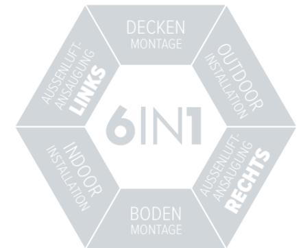
Ein **absolutes Highlight** der Vario-Geräte besteht in der **freien Wählbarkeit der Anschlussstutzen**. Ob die Außenluftansaugung **rechts** oder **links** vorgenommen wird, ist bei dieser Serie kurzfristig je nach den individuellen Voraussetzungen auf der Baustelle definierbar.
